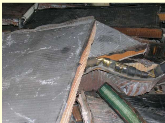
銅鋁混合廢料-廢水箱
